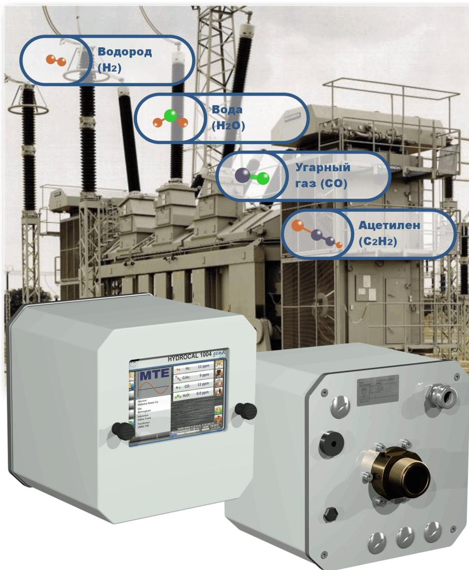
Новый HYDROCAL 1004 *genX* это первое полностью необслуживаемое решение онлайн-DGA для нескольких газов, сочетающее в себе проверенную ближнюю инфракрасную технологию измерений (NIR) с мембранной экстракцией, защищенной от вакуума
